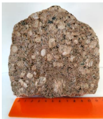
Рис. 1. Характерная порфировая структура исследуемого гранита, образованная преимущественно из крупных кристаллических вкраплений полевых шпатов
