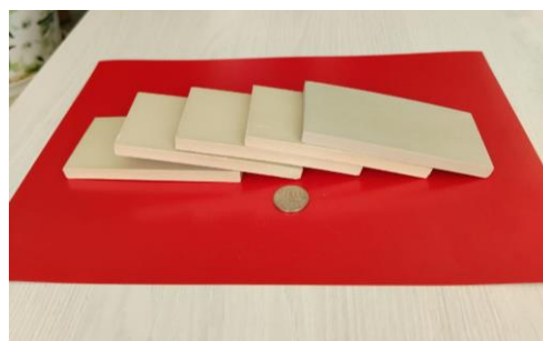
Рис. 7. Образцы керамогранитовых плиток на основе разработанных составов и полученных в заводских условиях
