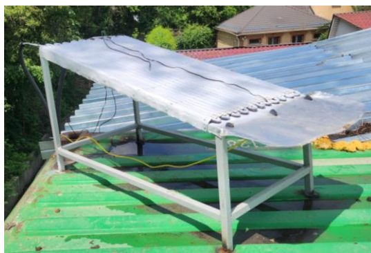
Рис. 3. Конструкция радиационно-испарительного конденсатора
