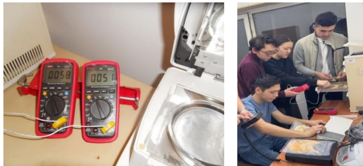
Сурет 4. Термोजұптар арқылы қауын массасының ішкі температурасы мен кептіру камерасының ортасындағы температураны өлшеу үшін қолданылған RGK DM-30 цифрлы мультиметр аспабы
