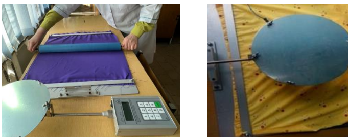
Сурет 1. №1 үлгінің электрленгіштік көрсеткішін өлшеу
