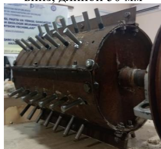
Колково-планчатый барабан, конус которого направлен вниз, и установленными конусообразными колками
