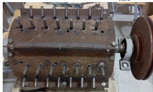
Колково-планчатый барабан, конус которого направлен вниз, и установленными конусообразными колками
