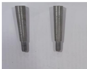
Кольшек с конусообразным наконечником, направленным вниз, длиной 50 мм
