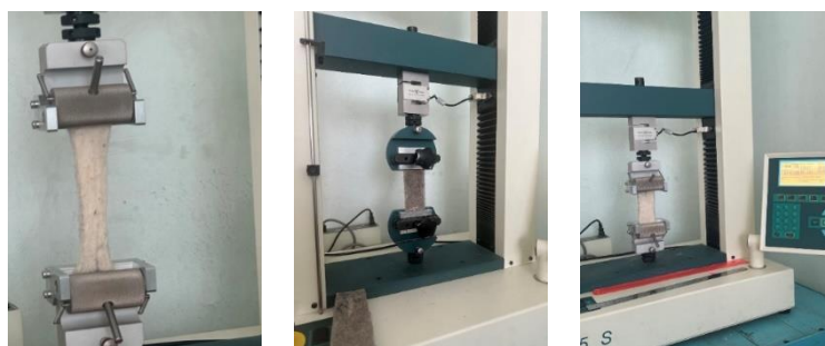
Сурет 3. Tinius Olsen H25S әмбебап ұзу машинасында үлгілердің беріктік сипаттамаларын анықтау
