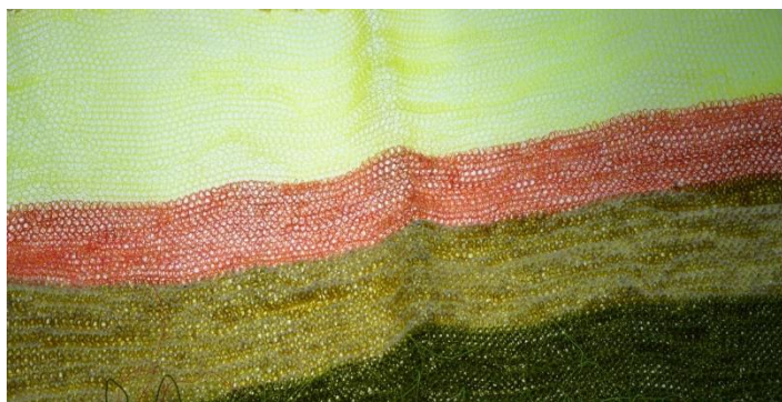
Рис. 4. Эффект светоотражения трикотажного полотна с ПОВ (лист 1)
