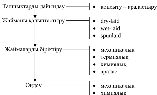
Сурет 1. Беймата материалдарды өндірудің технологиялық процесінің сызбасы
