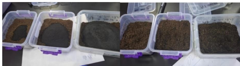
Сурет 5. Қорғасынмен ластанған топыраққа биокөмірді әртүрлі мөлшерде (5 г, 25 г, 50 г) қосып, біркелкі араластыру арқылы эксперименттік үлгілер дайындау сәті
