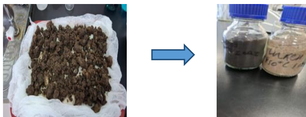
Сурет 2 .Тауық көнінен биокөмір өндіру процесі
