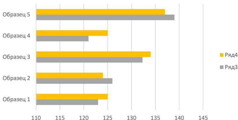
Рис. 2. Разрывная нагрузка образцов нетканых материалов, Н
