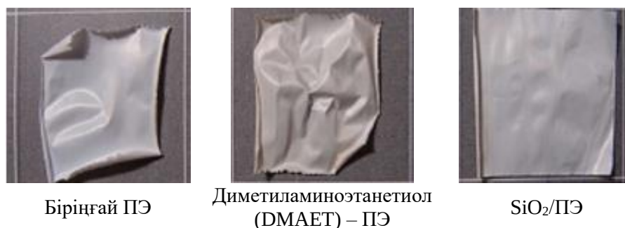
Сурет 3. 1 сағатта 140^\circ\text{C} -қа әсер еткеннен кейін әртүрлі сепараторлардың шынайы кескіндері
