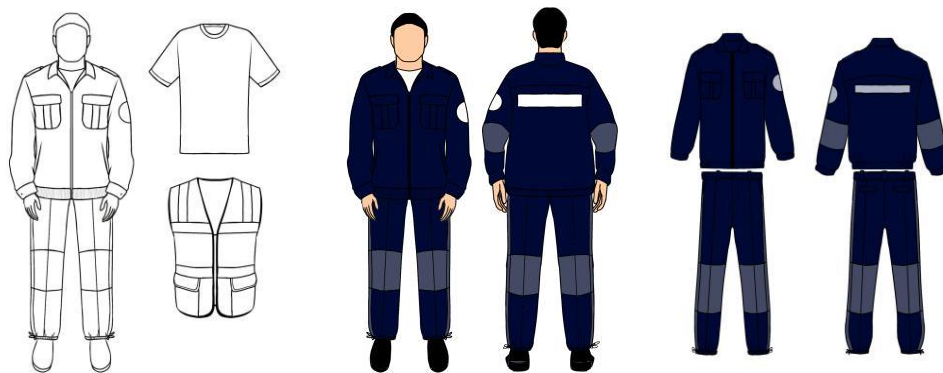
Сурет 2. Әскерилендірілген теміржол қызметкерлерінің арнайы киімінің конструкциялық шешімдерін ескере отырып жасалынған техникалық эскизі
