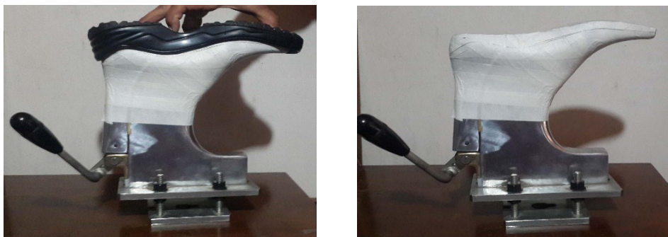
Рис. 2. Нанесение контура бокового обжима – бортика подошвы
