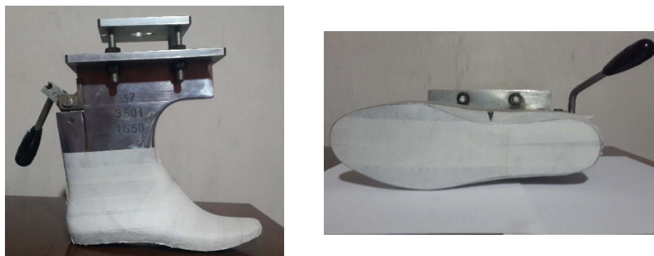
Рис. 1. Оклеивание боковой поверхности и следа колодки клеевой бумажной лентой
