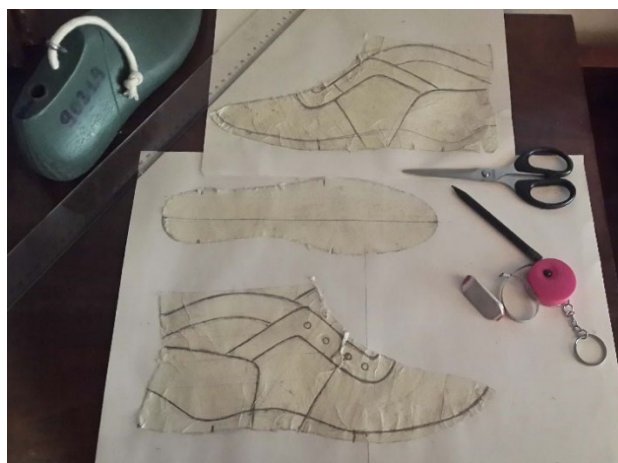
Рис. 4. Распластывание оболочки колодки
