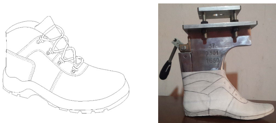
Рис. 3. Эскиз проектируемой модели и нанесение линий модели
