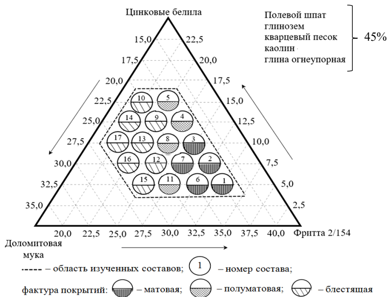
Рис. 1. Составы исследуемых глазурей и характеристики фактуры их поверхности
