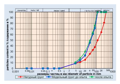
Рис. 1.График фракционного состава натурного грунта и модельной смеси до и после опыта
