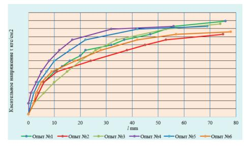
Рис.3. График зависимости  $\tau = f(\Delta l)$  при  $\sigma = 12$  кгс/см<sup>2</sup>
