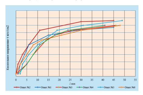
Рис.2. График зависимости  $\tau = f(\Delta l)$  при  $\sigma = 4$  кгс/см<sup>2</sup>
