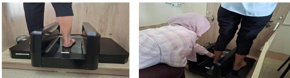
Рис. 2. Проведение замеров стопы женщин Шымкентского и Ташкентского регионов с помощью сканирующей системы INFOOT-2
