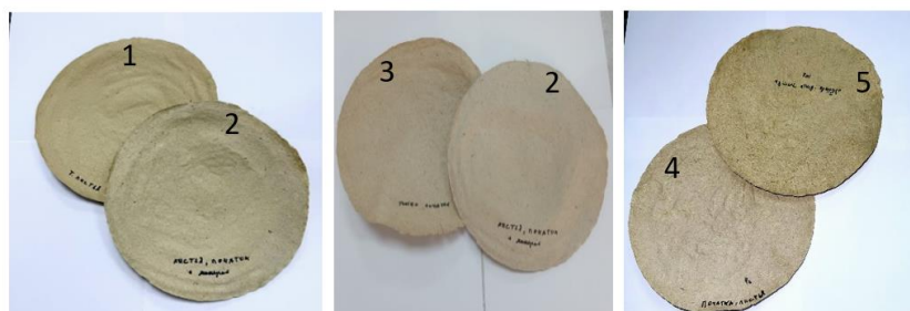
Рис. 5. Экспериментальные образцы картона из волокон листьев кукурузы и других частей растения: 1) ЛК, 2) ЛКЛП-2, 3) ЛП, 4) ЛКЛП-1, 5) СЧК.
