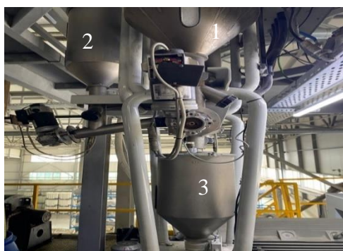
Сурет 1. Экструдерге арналған шикізат беру бункері және миксер:
