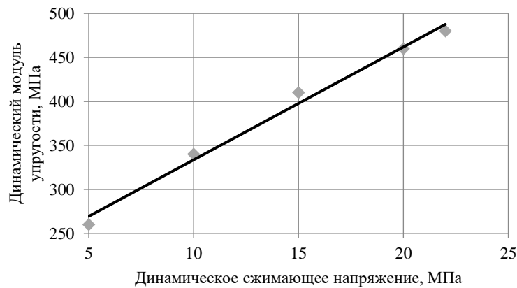
Рис. 5. Зависимость динамического модуля упругости амортизатора из дуба (при перпендикулярном расположении волокон относительно сжатия) от динамического сжимающего напряжения (при значении коэффициента уплотнения амортизатора 0,6)
